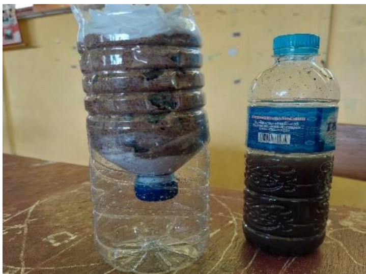
Gambar 6. Filter air sederhana yang dibuat siswa (Sumber: Dokumentasi tim pengabdian, 2023)
