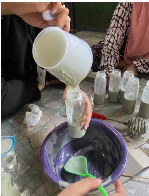
Gambar 5. Proses Pembuatan Minyak Jelantah Menjadi Sabun Cair (Sumber: Dokumentasi tim pengabdi, 2023)
